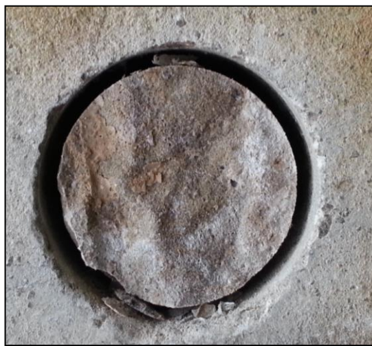
Obrázek 5: Fotodokumentace odtrhové zkoušky, vlevo odtržená panenka s vrstvou povrchové úpravy, vpravo plocha po odtržení panenky
